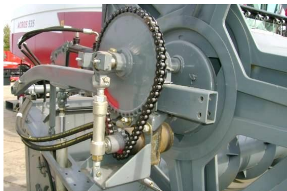
Рисунок 2. Комбайн зерноуборочный самоходный РСМ-142 «ACROS-535». Гидропривод мотовила. 1 – гидромотор, 2 - поддержка мотовила, 3 – цепная передача, 4 – мотовило.
