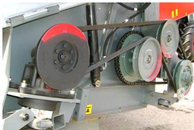
Рисунок 1. Комбайн зерноуборочный самоходный РСМ-142 «ACROS-535». Привод режущего аппарата. 1 - приводной шкив, 2 - натяжные ролики, 3 – планетарный редуктор «Шумахер».
