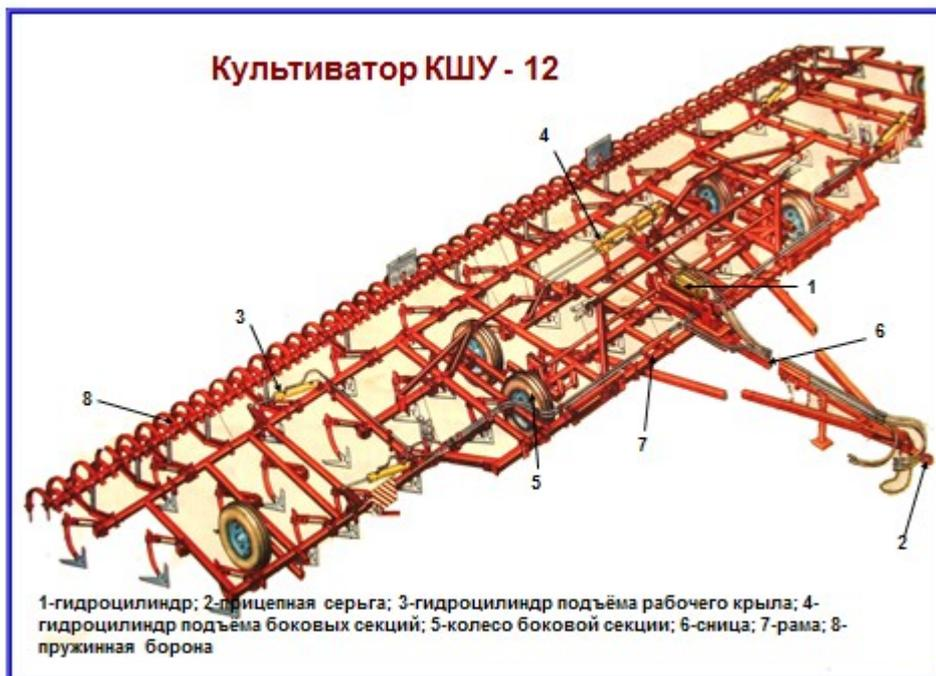
Устройство: рама, пружинная боронка, рабочие органы, подвеска, спаренные колёса, колёса боковых секций, прицеп, гидроцилиндры, механизмы подката колёс и регулировки глубины хода рабочих органов, маслопроводная сеть, заравнивающее устройство.
