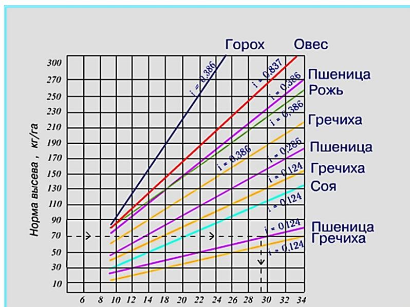
*Диаграмма нормы расхода зерновых и зернобобовых культур при определённой длине рабочей катушки*
